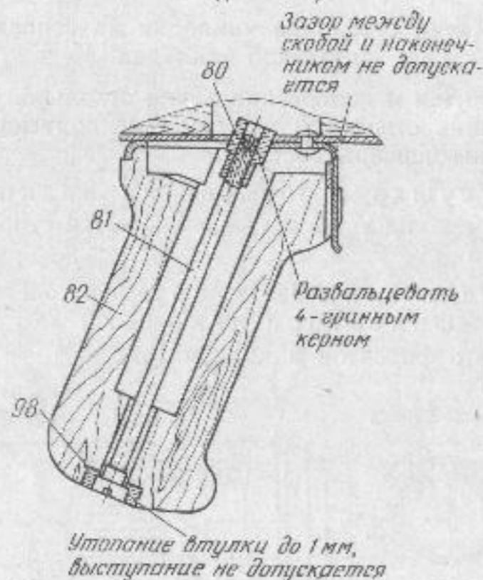
Рис. 31. Устранение качки рукоятки в соединении со ствольной коробкой:
