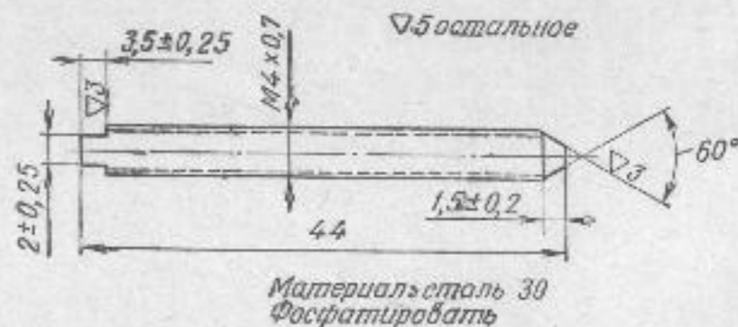
Рис. 95. Шпилька \frac{5-15}{56-A-212}
