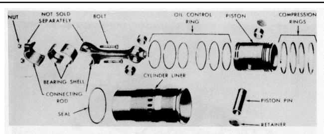
**CONNECTING ROD, PISTON AND LINEAR**
