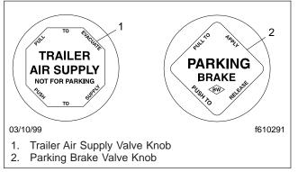
Fig. 6.3, Brake Valve Knobs
