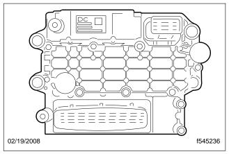
Fig. 2.24, Motor Control Module (MCM)
