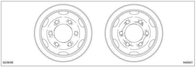
Fig. 11.6, Worn Stud Holes
