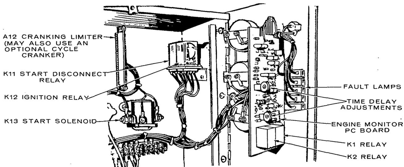
FIGURE 28. LOCATION OF DC CONTROL COMPONENTS
