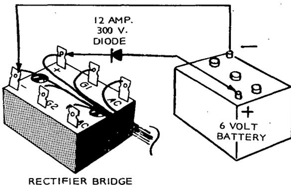
FIGURE 24. FIELD FLASHING CIRCUIT
