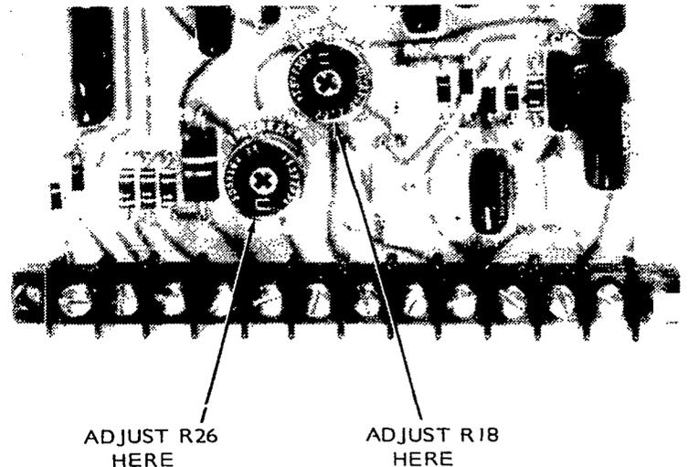
FIGURE 21. ADJUSTING VOLTAGE ON VR21
