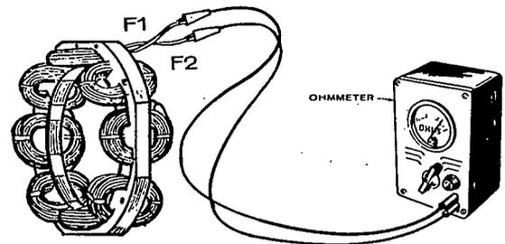
FIGURE 16A. TESTING EXCITER FIELD
