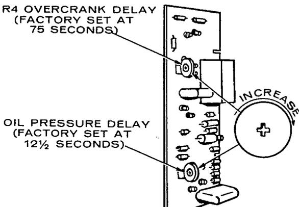
FIGURE 31. ADJUSTING TIME DELAYS ON SINGLE LAMP ENGINE MONITOR
