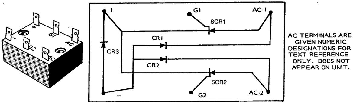
FIGURE 26. RECTIFIER ASSEMBLY
