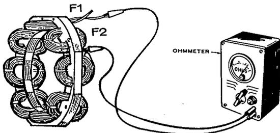
FIGURE 16. TESTING EXCITER FIELD
