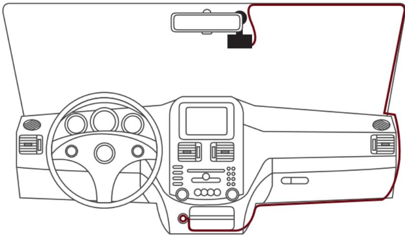
1. Une fois l'emplacement choisi, fixez le support de la caméra grâce à la bande d'adhésif 3M. Nettoyez bien l'emplacement sur la vitre avant d'appliquer le support, enlevez la protection sur l'adhésif et pressez fermement le support contre la vitre pendant environ 2 minutes. L'effacité de l'adhésif est de 50% après 20 minutes, 100% après 72 heures. Si vous accrochez la caméra à son support trop tôt, l'adhésif peut ne pas coller efficacement à la vitre.
