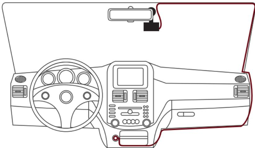
1. Wenn Sie sich für eine geeignete Stelle für die Installation der Kamera entschieden haben, befestigen Sie zunächst die Kamerahalterung mit Hilfe des 3M Klebestreifens an der Windschutzscheibe. Stellen Sie dazu sicher, dass die Scheibe sauber ist, entfernen Sie die Schutzfolie und drücken Sie die Halterung für ca. 2 Minuten kräftig gegen das Glas. Warten Sie dann noch etwa 20 Minuten, bevor Sie die Kamera an der Halterung befestigen.
