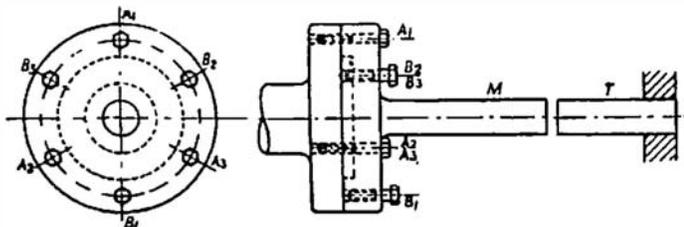
Fig. 51. Double Mandrel Test
